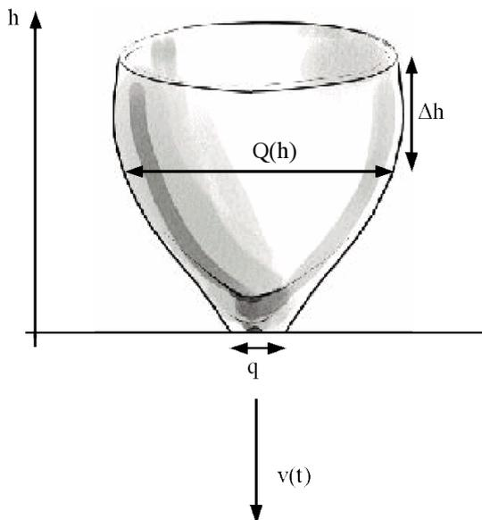
Beachte:  $q$  und  $Q$  sind Querschnittsflächen. Während  $q$  gleichbleibt, ändert sich  $Q$  mit der Höhe. Die Ausfluss-geschwindigkeit  $v(t)$  ändert sich ebenfalls mit der Zeit!
